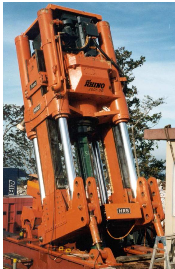
Abb. 2: Die für diesen Auftrag investierte Raisebohrmaschine Rhino
