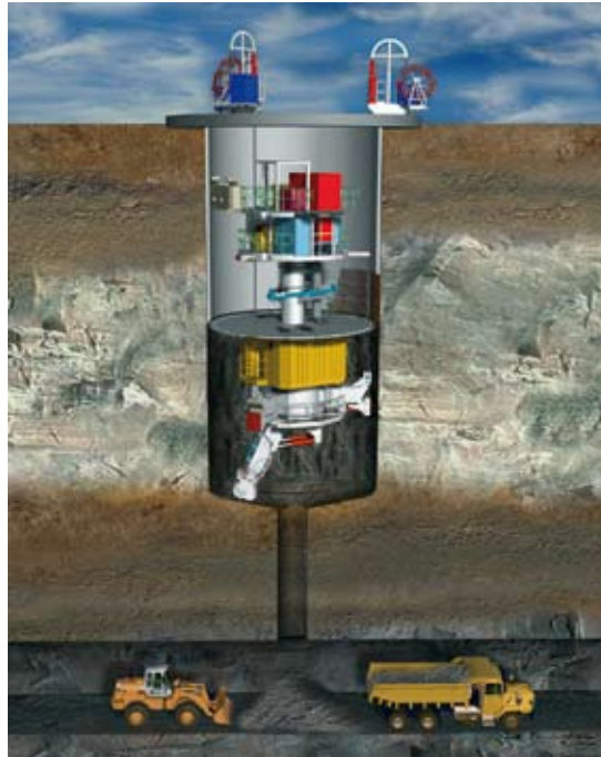
Рис. 6. Установка стволопроходческого бурового агрегата на передовой скважине
