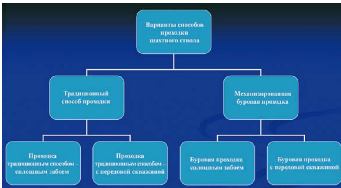
Рис. 4. Способы проходки шахтного ствола
