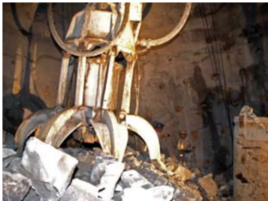
Рис. 1. Многочелюстной проходческий грей- фер
