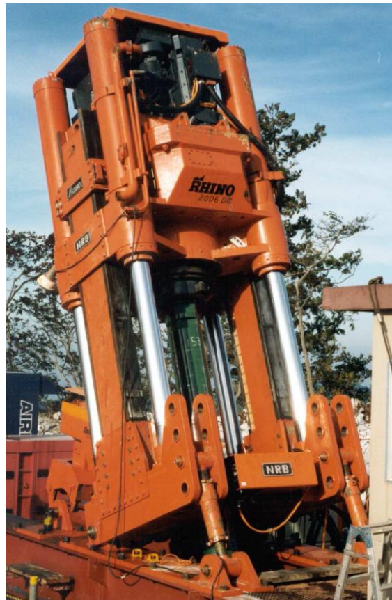
Рис. 2: Установка для бурения восстающих выработок РИНО, приобретенная для данного подряда
